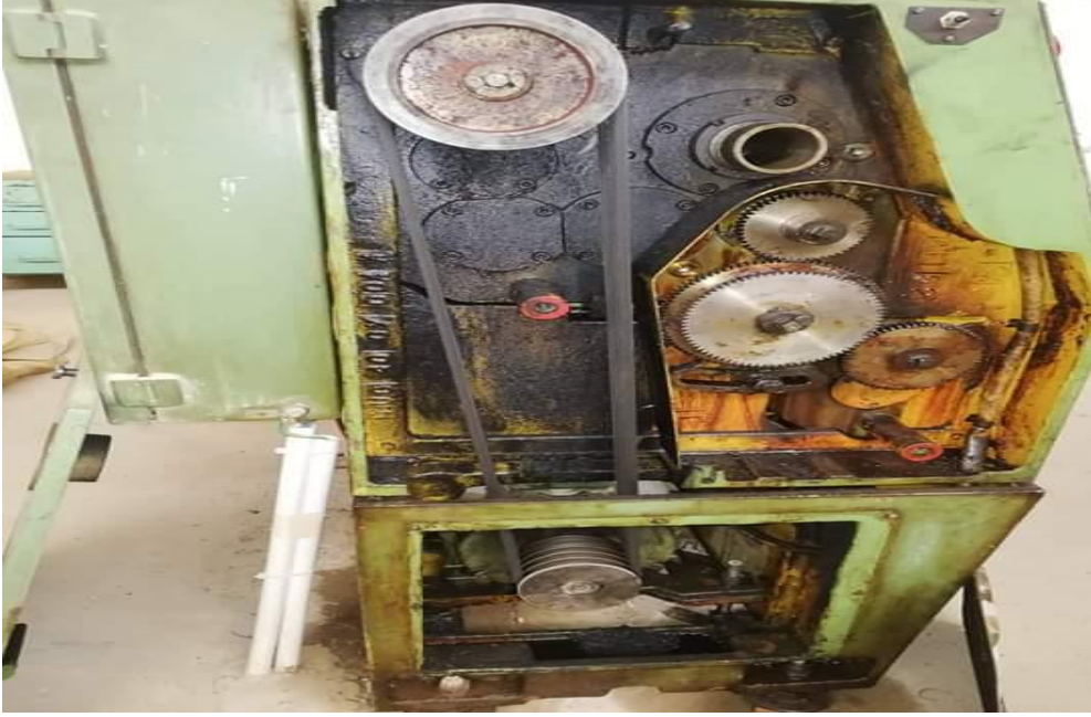
شكل (12) يوضح عدد ونوع السيور في آلة المخروط
