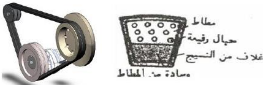
شكل (4) يوضح سير اسفيني على شكل حرف V
