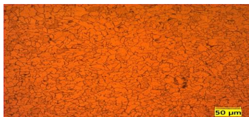
شكل (8) صورة مجهرية لعينة St-37 (X200)
