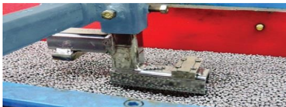
شكل (3) جهاز التشكيل بالدق الاهتزازي الشديد (SVP)
