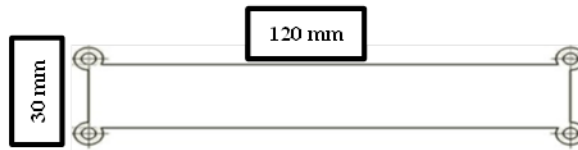
شكل (1) أبعاد عينة St-37 لعملية (SSPD)
