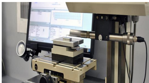
شكل (6) جهاز قياس خشونة سطح للعينات
