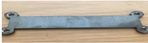
شكل (2) عينة St-37 لعملية (SSPD)
