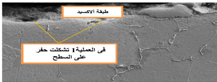
شكل (13) (a) صور المجهر الإلكتروني الماسح للسطح بعد عملية 1
