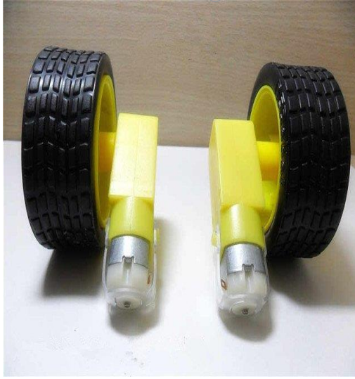
الشكل (2-5) يوضح محرك تيار مستمر مع عجلة تروس متصلة به .
