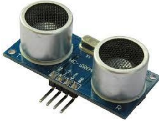
شكل (12-5) يوضح شكل حساس موجات ما فوق الصوتية (Ultrasonic HC-SR04) .
